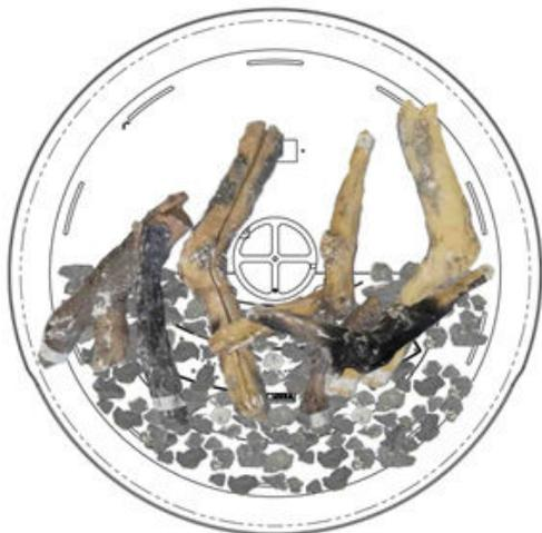
Ponga el tronco 7 como se muestra arriba, la disposición está ahora completa. Asegúrese de que el área del Piloto sigue estando despejada, y compruebe que el Piloto está correctamente encendido y que el Piloto enciende el quemador principal sin problemas.
